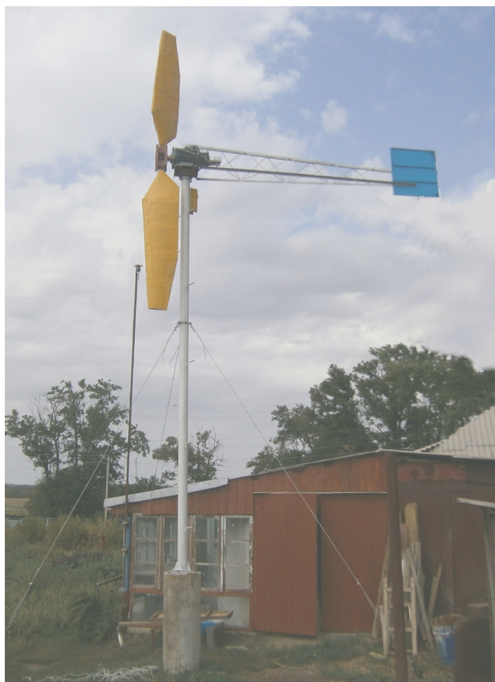
Рисунок 7 — Внешний вид действующей ветроустановки для проведения экспериментальных исследований
