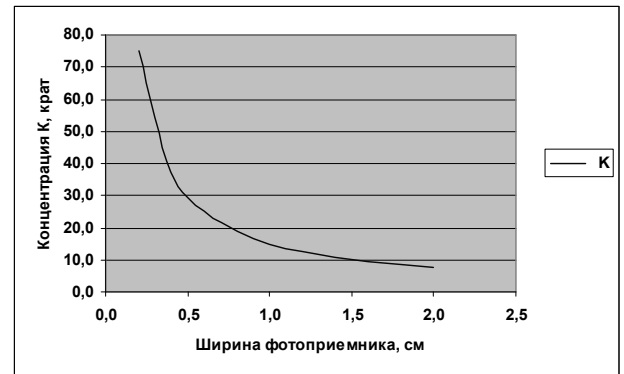
Рис. 2. Зависимость геометрической концентрации модуля от ширины фотоприемника
