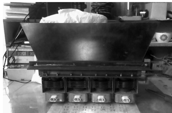
Рис. 10. Рупор для формирования направленности излучения
