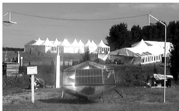
Рис. 2. Стационарный концентратор с солнечной батареей для автономного питания резонансной системы освещения
