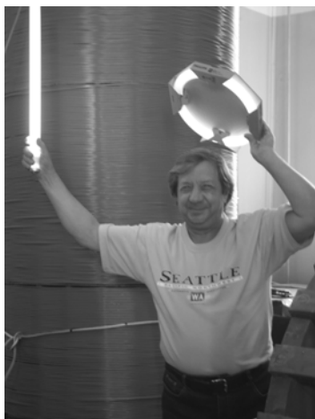
Рис. 5. Однослойная цилиндрическая катушка. Возбуждение от генератора гармонических колебаний (измерение электрических параметров катушки). Рабочий момент
